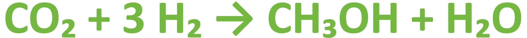
Les e-carburants comme le e-méthanol sont des **carburants de synthèse fabriqués en utilisant de l'électricité décarbonée**. La production de e-carburants à faibles émissions passe par une étape de production d'hydrogène décarboné, transformée ensuite en d'autres molécules par différents processus chimiques.
