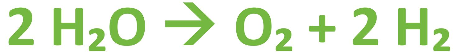
L'électrolyse de l'eau permet, sous l'effet d'un courant électrique, de décomposer l'eau en deux éléments : l'hydrogène et l'oxygène.
