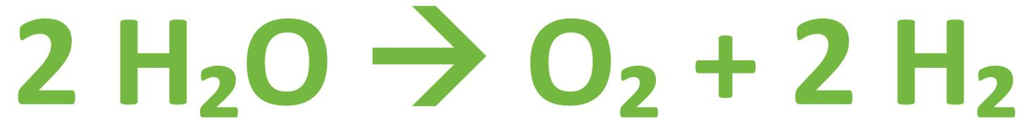
L'hydrogène bas carbone produit par H2V Marseille Fos serait produit par **électrolyse de l'eau**, procédé qui décompose l'eau en hydrogène et en oxygène, **sous l'effet d'un courant électrique**. Il s'agit d'une technologie mature, fiable et efficace.
