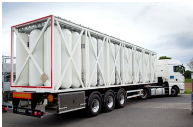
Distribution de l'hydrogène par camion
